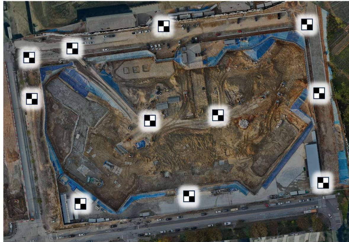
現場の周囲にバランスよくGCPを配置し、それぞれの地点におけるGPS座標を基に、測量データの精度を高めます。
